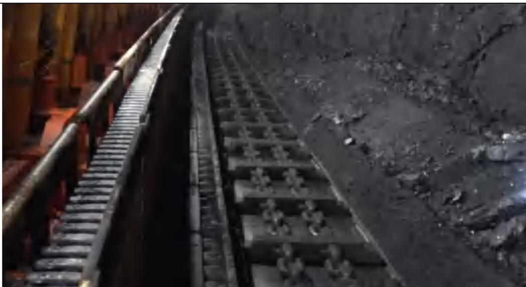
图3 工作面刮板输送机
