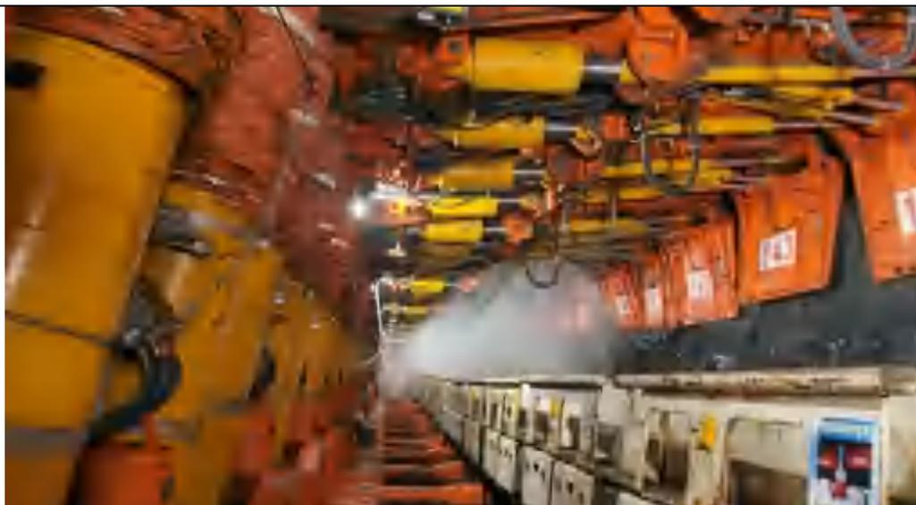
图1 工作面工作阻力 18000kN 的液压支架
