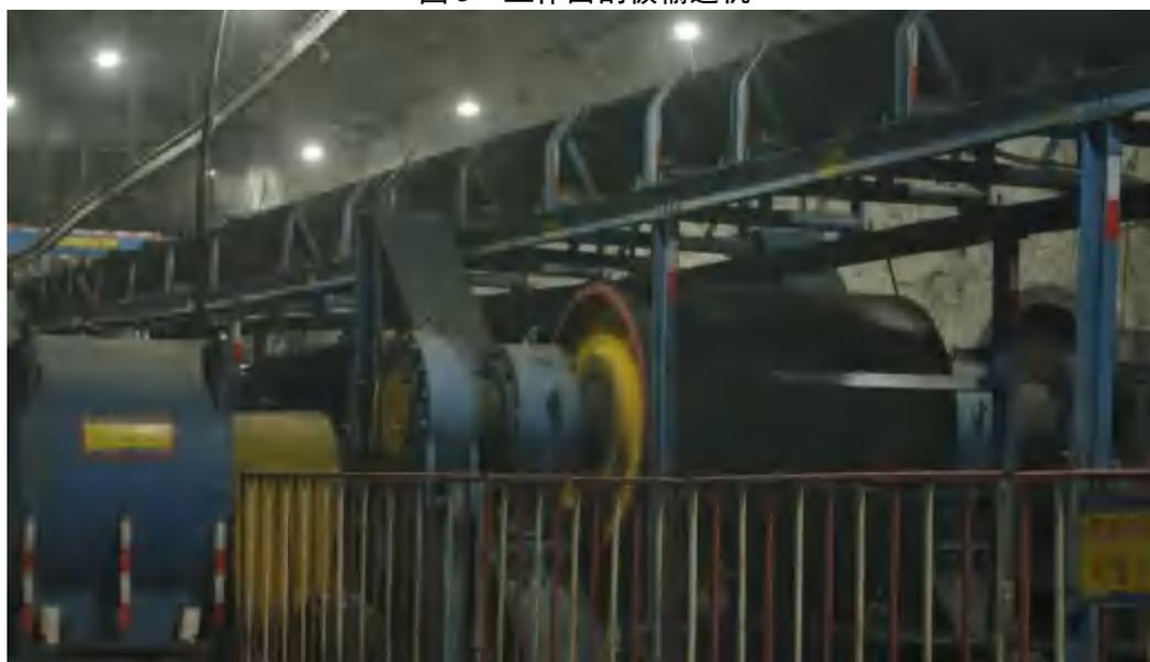
图4 DSJ140/300/4×500S 型带式输送机
