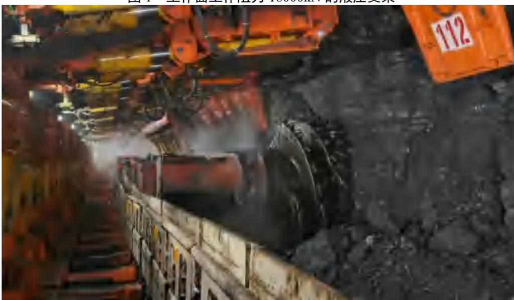
图2 MG900/2400-WD 型采煤机
